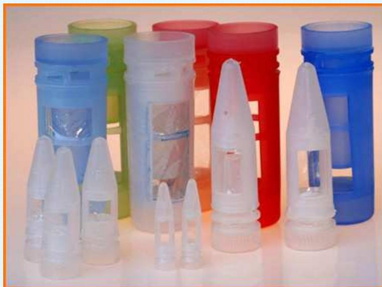
Biovision 所提供的 DiaEasy™ Dialyzer tubes 產品線提供了一系列簡單易用的透析膜管，根據透析膜孔徑大小區分為 1 kDa、3.5 kDa、6-8 kDa、12-14 kDa、25 kDa 及 50 kDa，提供的透析體積由 10  $\mu$  L 至 20 mL，所有的樣品皆由上方裝入透析膜管中，使用螺旋蓋拴緊後，再放上內附的浮板漂浮在 buffer 上方，這樣可以保持管口不與 buffer 接觸，減少污染的疑慮，而且透過螺旋管，使用上更佳方便。DiaEasy™ Dialyzer tubes 除了可以用於蛋白質純化，也可以用於核酸純化。
